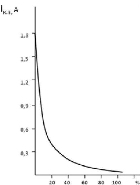
Рисунок 3 – Зависимость тока короткого замыкания от заснегенности солнечных панелей
