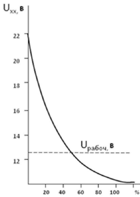
Рисунок 2 – Зависимость напряжения холостого хода от заснегенности солнечных панелей
