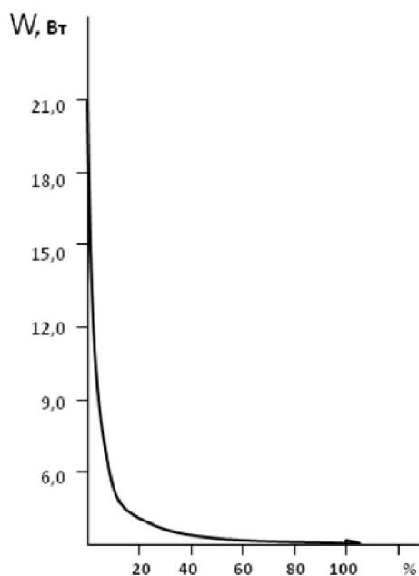
Рисунок 4 – Зависимость мощности от заснегенности солнечных панелей
