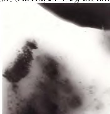
3 сурет - 5%MoCrGa/ТБ+ИК-30 өңделген катализатордың электрондық микроскоп суреті. α-GaOOH (ASTM, 26-674), Cr 0,17 Mo 0,83 O 2 (ASTM, 34-473), CrMoO 4 (ASTM, 29-452)
