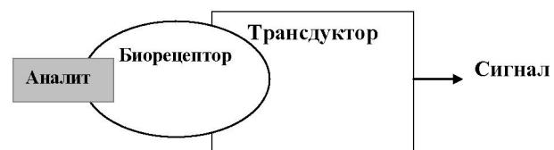
Биосенсор включает чувствительный биологический элемент (фермент, антитело, бактериальная клетка, ДНК), который соединен с преобразователем сигнала. Сигнал же детектируется физико-химическими методами. Наиболее распространены электрохимические, оптические и акустические методы усиления сигнала.
